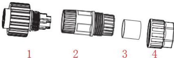
1. 配套插座; 2. 套筒; 3. 套筒; 4. 密封螺母
